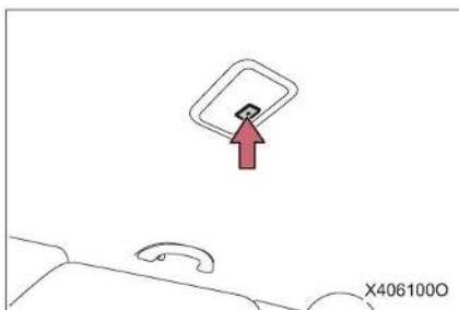
Presione el interruptor para encender/apagar las luces interiores traseras.
