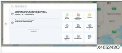
Toque [Buscar los puntos de paso] en la interfaz de búsqueda de puntos de paso para acceder a la interfaz de búsqueda. Puede añadir puntos de paso buscando por palabras clave, puntos recibidos, puntos seleccionados en el mapa, puntos favoritos, etc.
