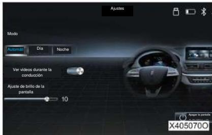
En la pantalla de ajuste de la pantalla, puede seleccionar el modo de visualización (automático/día/nocturno), activar/desactivar la visualización de vídeo durante la conducción, ajustar el brillo de la pantalla y apagarla.
