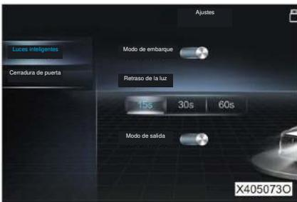
Toque [Luz inteligente] en el ajuste de confort para entrar en la interfaz de ajuste de la luz inteligente.
