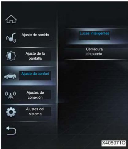
La interfaz de ajustes de confort le permite ajustar las luces inteligentes o las cerraduras de puerta.
