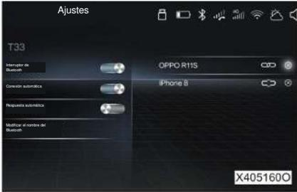
Después de que el interruptor de Bluetooth esté activado, se mostrarán en la interfaz de ajuste de la conexión Bluetooth los dispositivos conectados actual y pasadamente.
