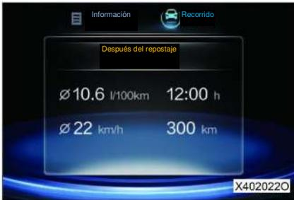
Se muestra el consumo medio de combustible, el tiempo de viaje, la velocidad media y el subtotal de kilómetros después de repostaje.
