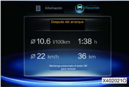
Se muestra el consumo medio de combustible, el tiempo de viaje, la velocidad media y el subtotal de kilómetros después de arranque.
