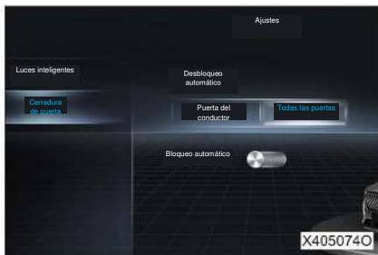
Toque [Cerradura de puerta] en el ajuste de confort para entrar en la interfaz de ajuste de la cerradura de puerta.
