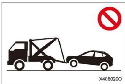
Está estrictamente prohibido remolcar con remolques de carga elevada para dañar la carrocería.
