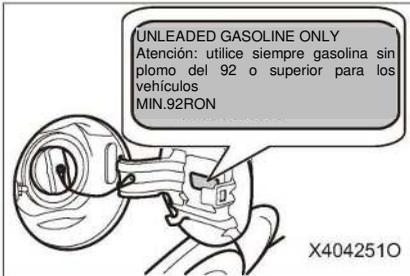
La tapa del puerto de llenado está etiquetado con una etiqueta de precaución, por lo que debe asegurarse de utilizar el tipo de combustible especificado.
