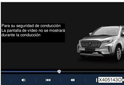
Si el interruptor "Ver vídeo mientras se conduce" en los ajustes de la interfaz está desactivado, la interfaz de vídeo no se mostrará si la velocidad del vehículo es superior a una velocidad determinada en la interfaz de reproducción de vídeo USB.
