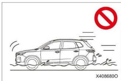
Si se circula por carreteras anegadas, es fácil que el motor se pare, que se produzcan cortocircuitos en los componentes eléctricos y que entre agua. No intente arrancar el motor después de que se haya parado, ya que esto puede provocar graves daños en el motor.
